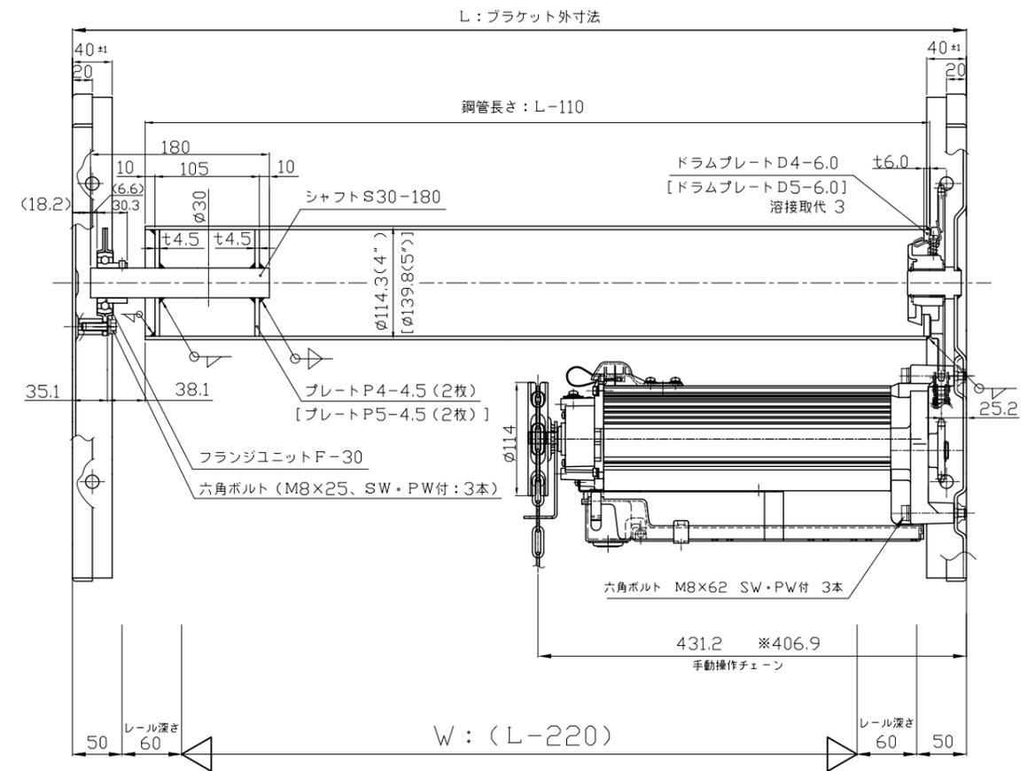
1. 納まり参考図の開閉機は、SHD13S形 障害物検知機能内蔵の右形を示します。
